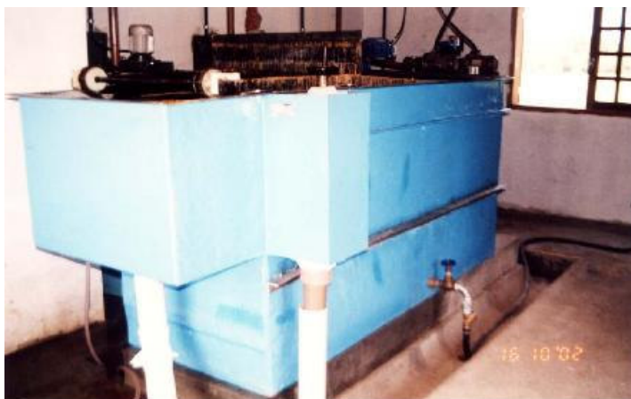
Figura 4. Célula de flotação em escala piloto (MENEZES, 2002 p. 15).
