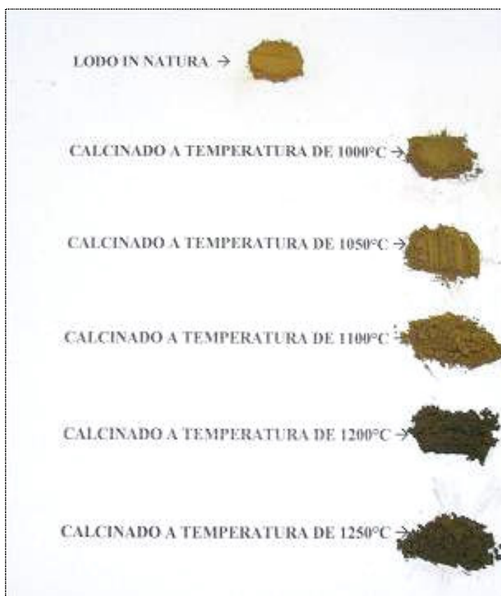
Figura 26. Resultados do lodo de DAM in natura calcinado em diferentes temperaturas.
